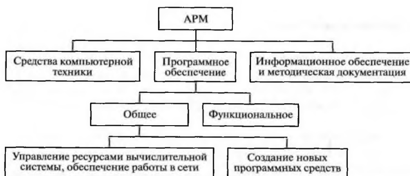
Рис. 1.1. Структура автоматизированного рабочего места специалиста
